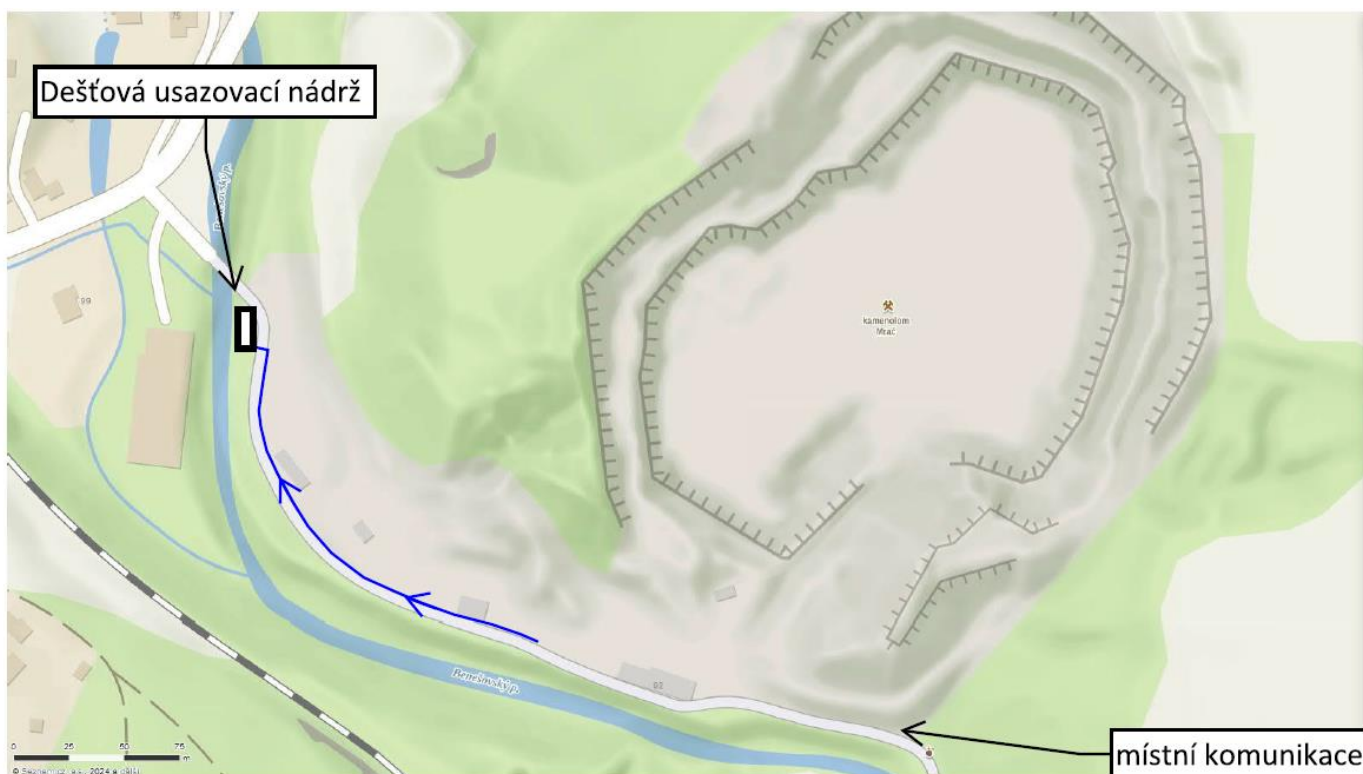
Schématické znázornění odvodnění manipulačního prostoru kamenolomu Mrač
