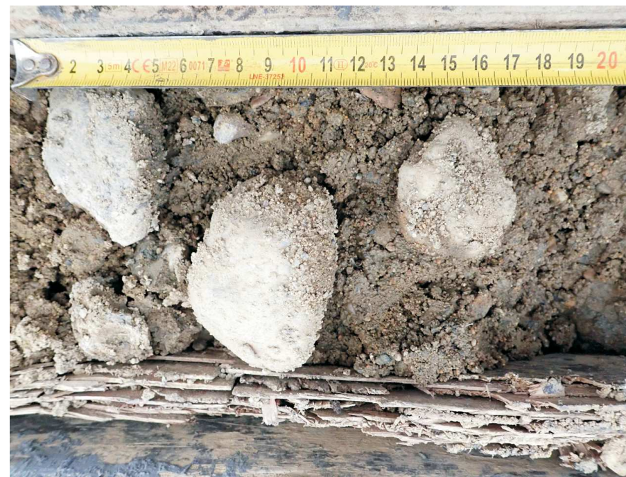
Foto 2. Fluviální písčité štěrky GT4. Vrtné jádro z vrtu V1 (metráž 1,45 - 1,65 m).
