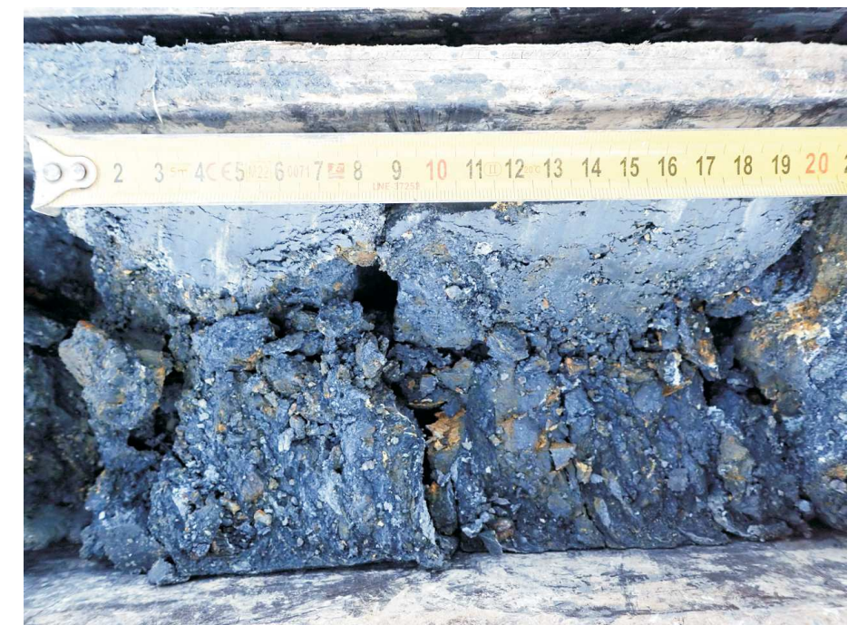
Foto 3. Velmi zvětralá grafitická břidlice GT5. Vrtné jádro z vrtu V3 (metráž 4,20 - 4,40 m).
