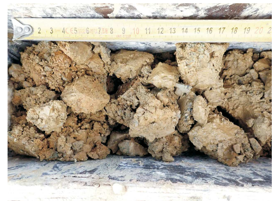
Foto 6. Fosilně slabě zvětralá prachovitá břidlice GT7. Vrtné jádro z vrtu V7 (metráž 3,00 - 3,20 m).
