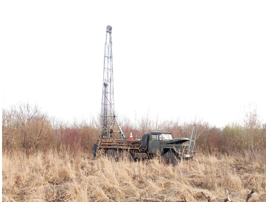
Foto 1. Vrtná souprava URB 2,5 A při realizaci vrtu V4.
