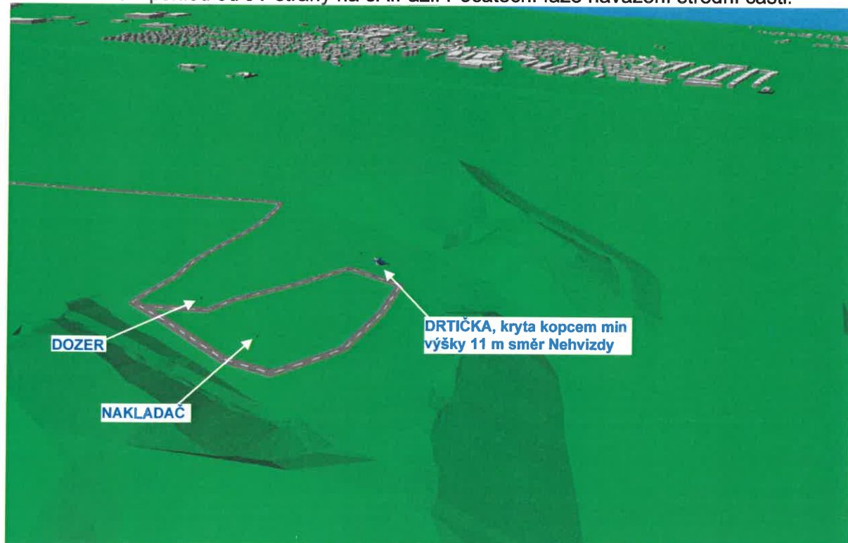
Obr.5-1E2: 3D pohled od JV strany na 3A.Fázi: Počáteční fáze navážení střední části.
