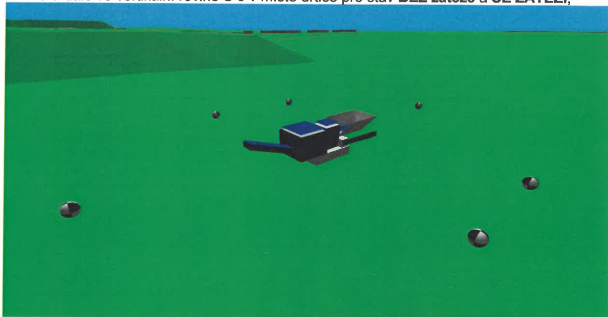
Obr. 5-1B: 3D pohled od SV strany na modelový zdroj drtičky typ OM CRUSHER ARGO TK141 , níže jsou pak 3D pohledy od SV strany s hlukovými pásmy v úrovni 2 m zobrazeny na terénu a dále ve vertikální rovině S-J v místě drtiče pro stav BEZ zátěže a SE ZÁTĚŽÍ ,
