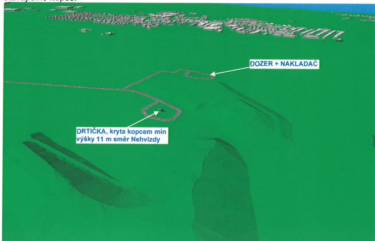
Obr.5-1C2: 3D pohled od JV strany na 1.Fázi: Navážení materiálu do severní části na úpatí stávajícího kopce.
