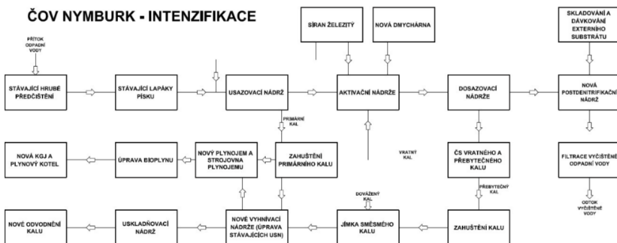
Obrázek 7 Blokové schéma ČOV Nymburk po intenzifikaci
