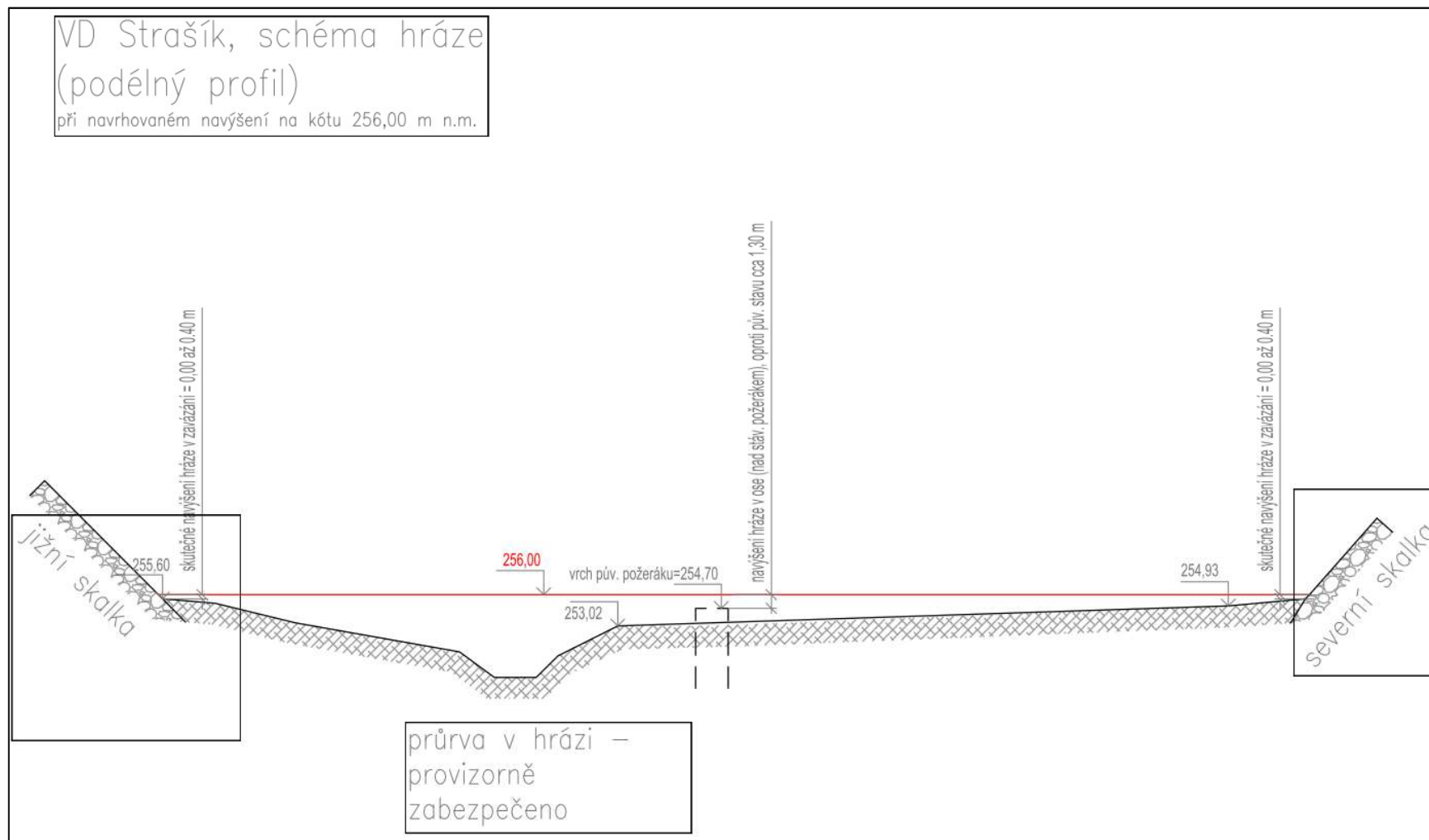
Obrázek č. 9: Schématický průřez hráze
