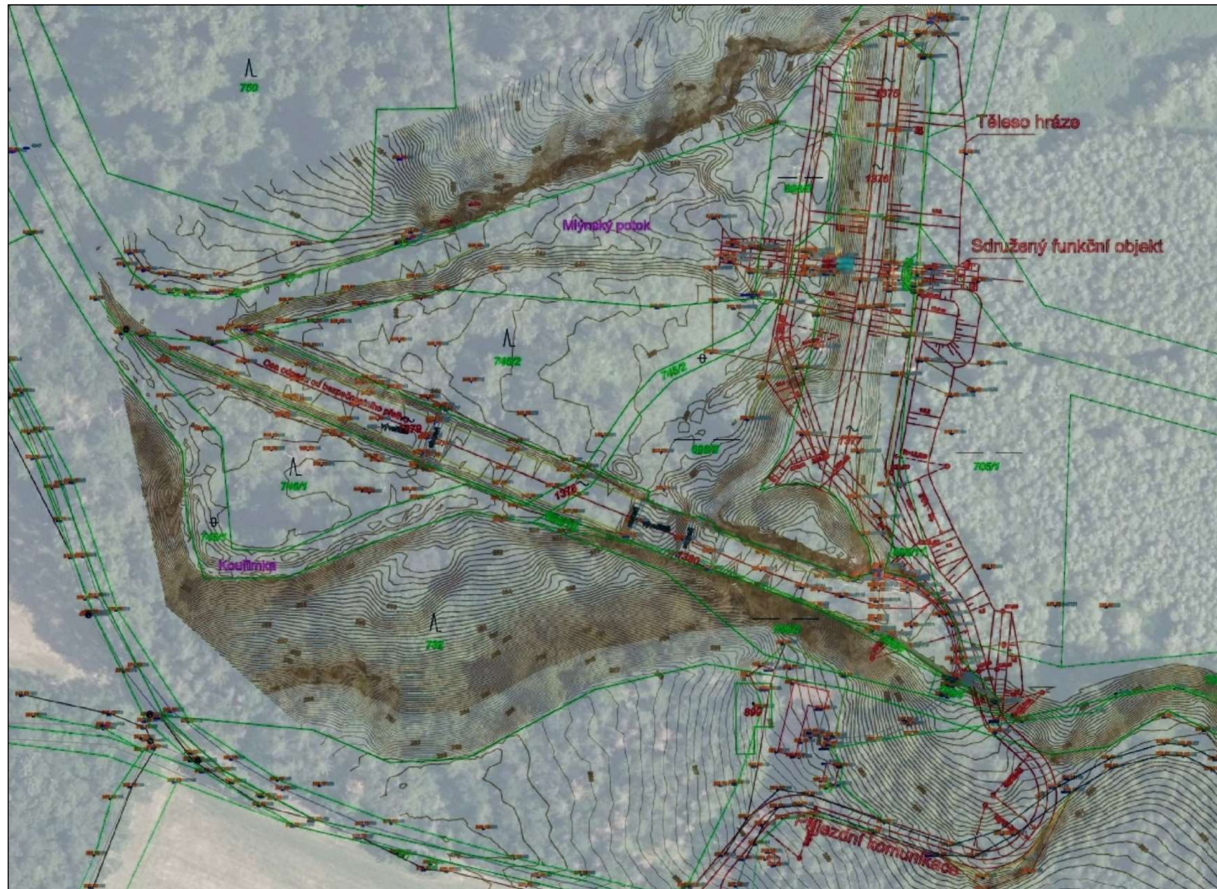
Obrázek č. 8: Koordinační situace výpustného zařízení záměru „VD Strašík, zvýšení retenční funkce rekonstrukcí VD“ (Geovap, 2017, Kvapilová, 2019) na podkladu ortofotomapy
