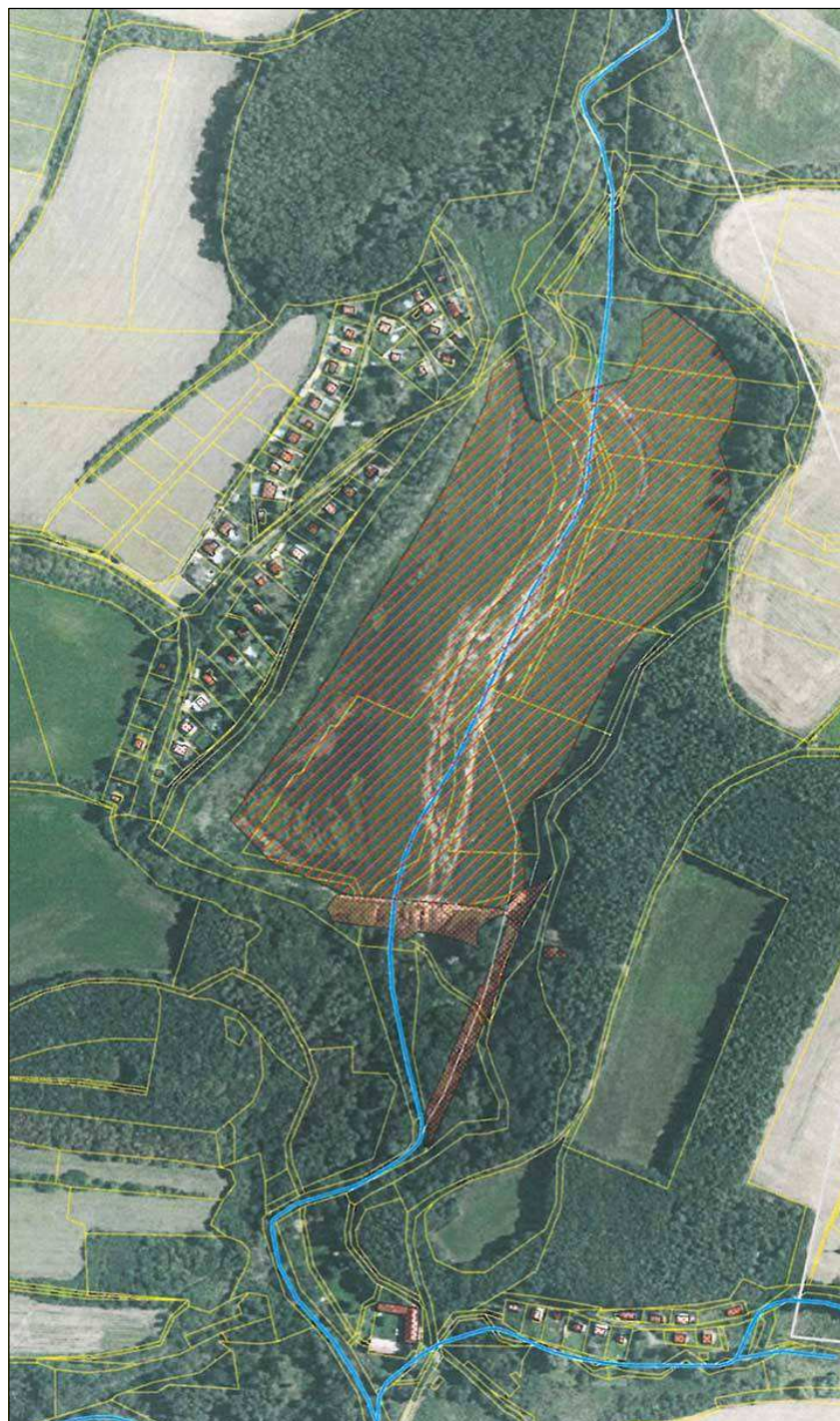
Obr. 9: „VD Strašík, odstranění nánosů“ – předpokládaná plocha těžení nánosů (červené šrafování; zdroj: SVATOŠ 2019).
