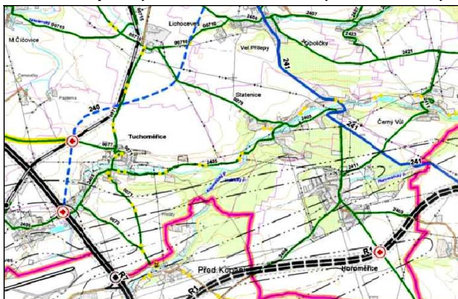
Obr. č. 3 Návrh přeložky silnice II/240 a obchvatu Prahy v ÚP VÚC Pražský region
