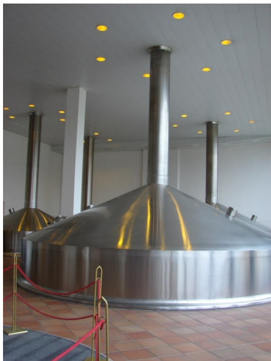
Objekt varny – varna slouží k výrobě mladiny extrakcí sladu a chmelovarem. Varna obsahuje rmutovací kotel, scezovací kád', chmelovarnou pánev a sběrač sladiny.
