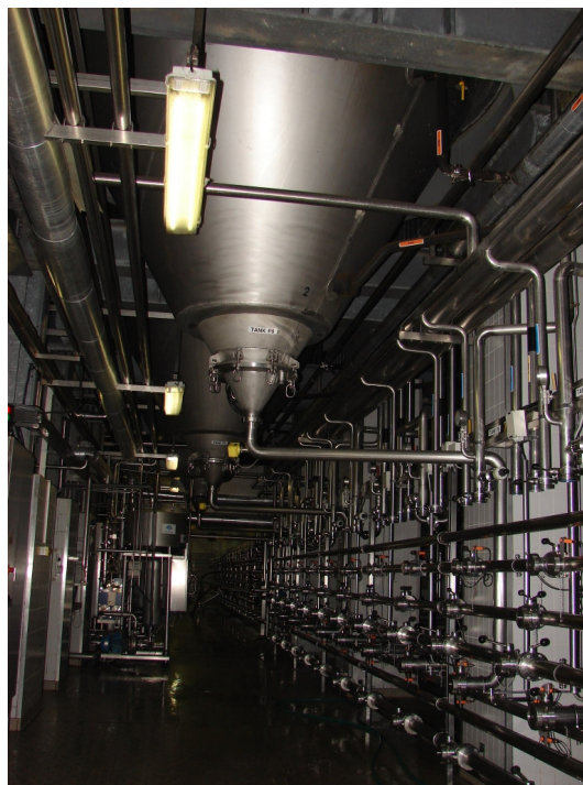
Objekt cylindrokónických tanků, ve kterých probíhá dvoufázově kvašení mladiny.
