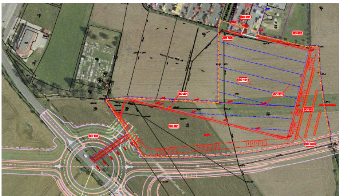
Obr.č. 4 Přehledná situace záměru rozšíření areálu PERI včetně návrhu budoucí OK II/101
