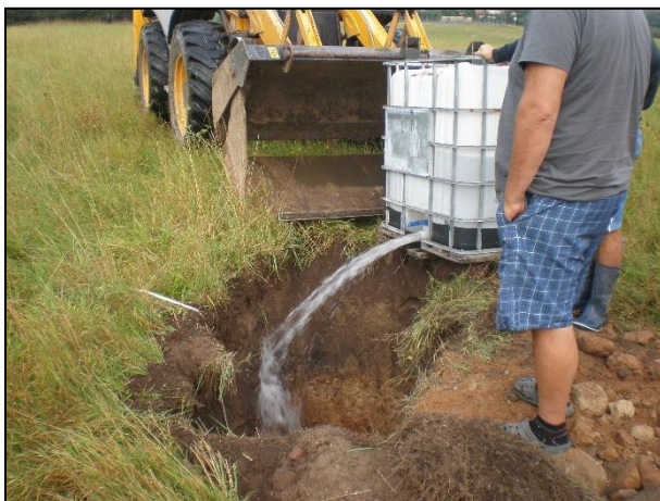
Napouštění kopané sondy č. 3 a měření poklesu hladiny vody
