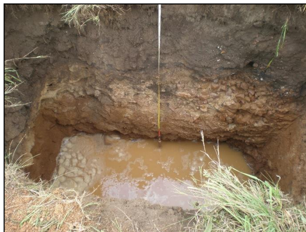
Napouštění kopané sondy č. 3 a měření poklesu hladiny vody
