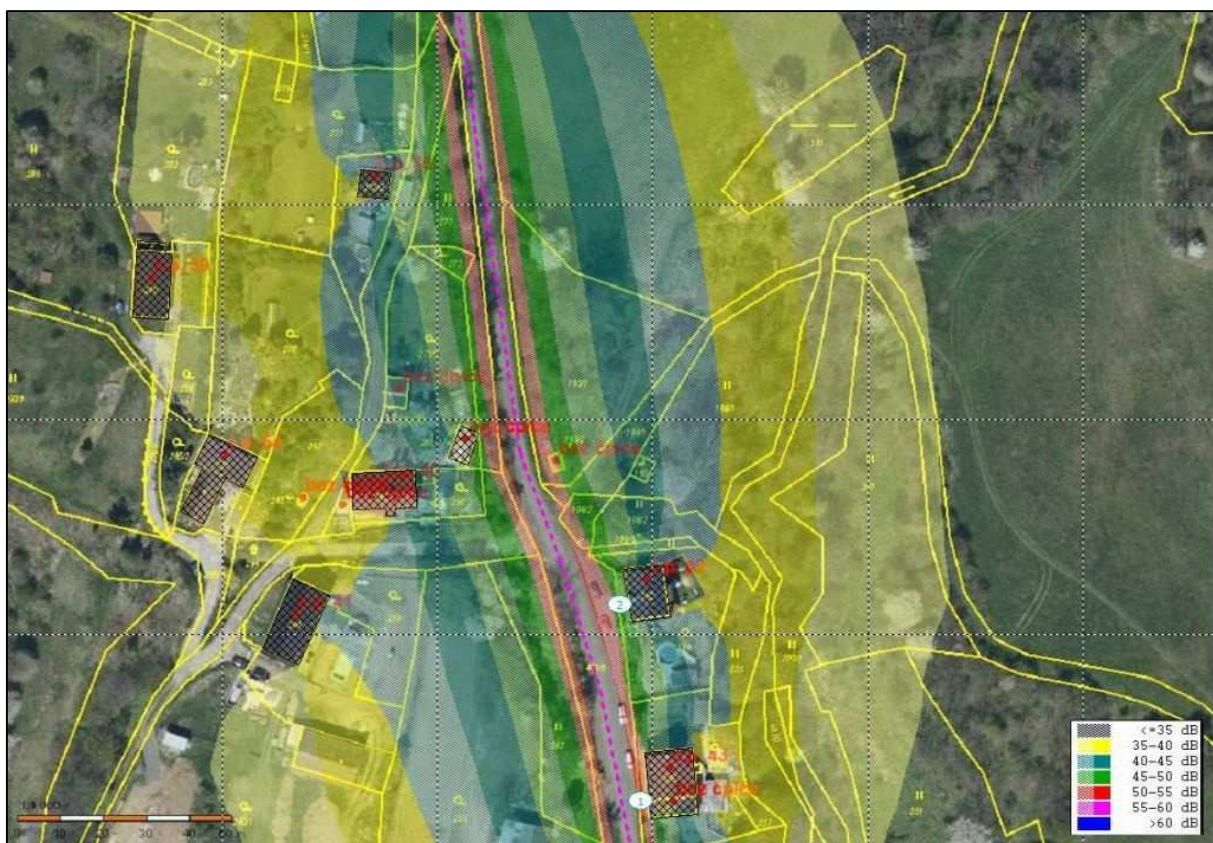
Hluková pásma ve výšce 3,0 m nad terénem – stavební doprava - Mlýniště
