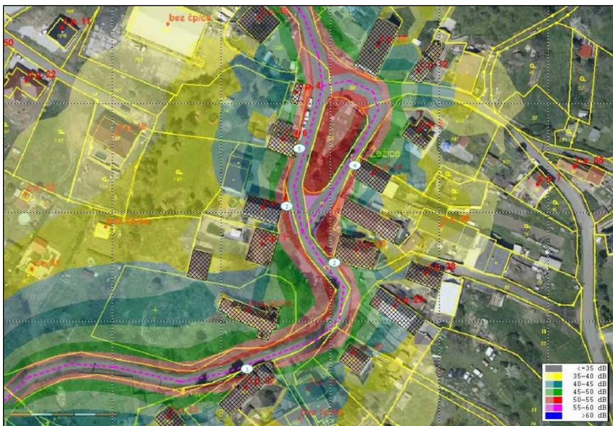
Hluková pásma ve výšce 3,0 m nad terénem – stavební doprava – Žežice
