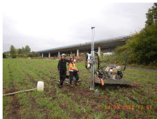
Obr. 5,6: Pohled k jihu na hloubení sondy S5 soupravou Argos-HH a přípravu nálevové vsakovací zkoušky.
