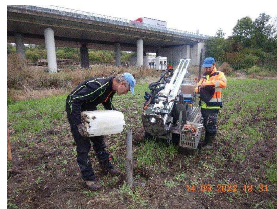
Obr. 5,6: Pohled k jihu na hloubení sondy S5 soupravou Argos-HH a přípravu nálevové vsakovací zkoušky.
