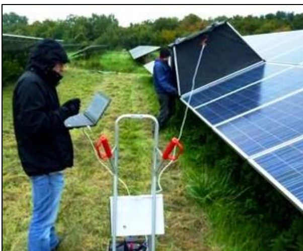
Obr. 19. Elektroluminiscence prováděná v terénu (Ilustrační snímek; Zdroj: TZB info, 2018)
