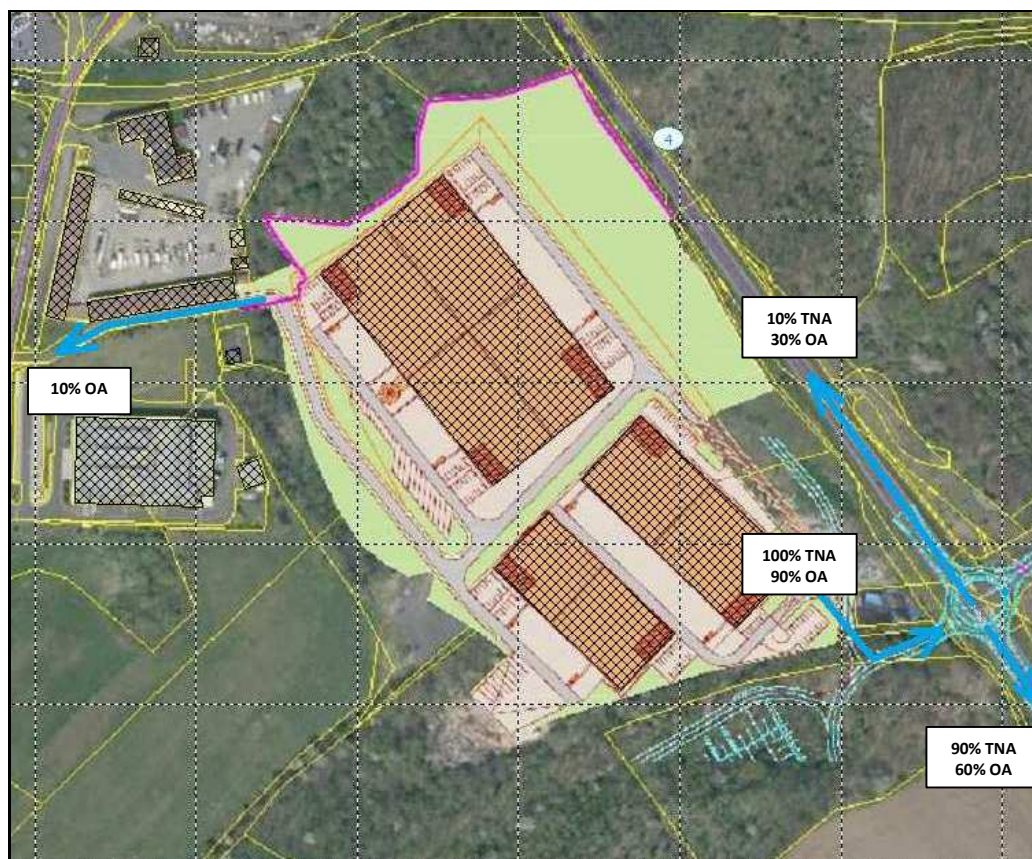
Obr. 4: Předpokládaný rozpad automobilové dopravy z areálu na silniční síti v zájmové oblasti
