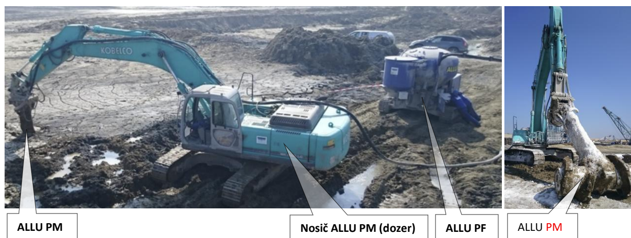
Obrázek č. 11: Ilustrační foto – mobilní stabilizační systém ALLU
