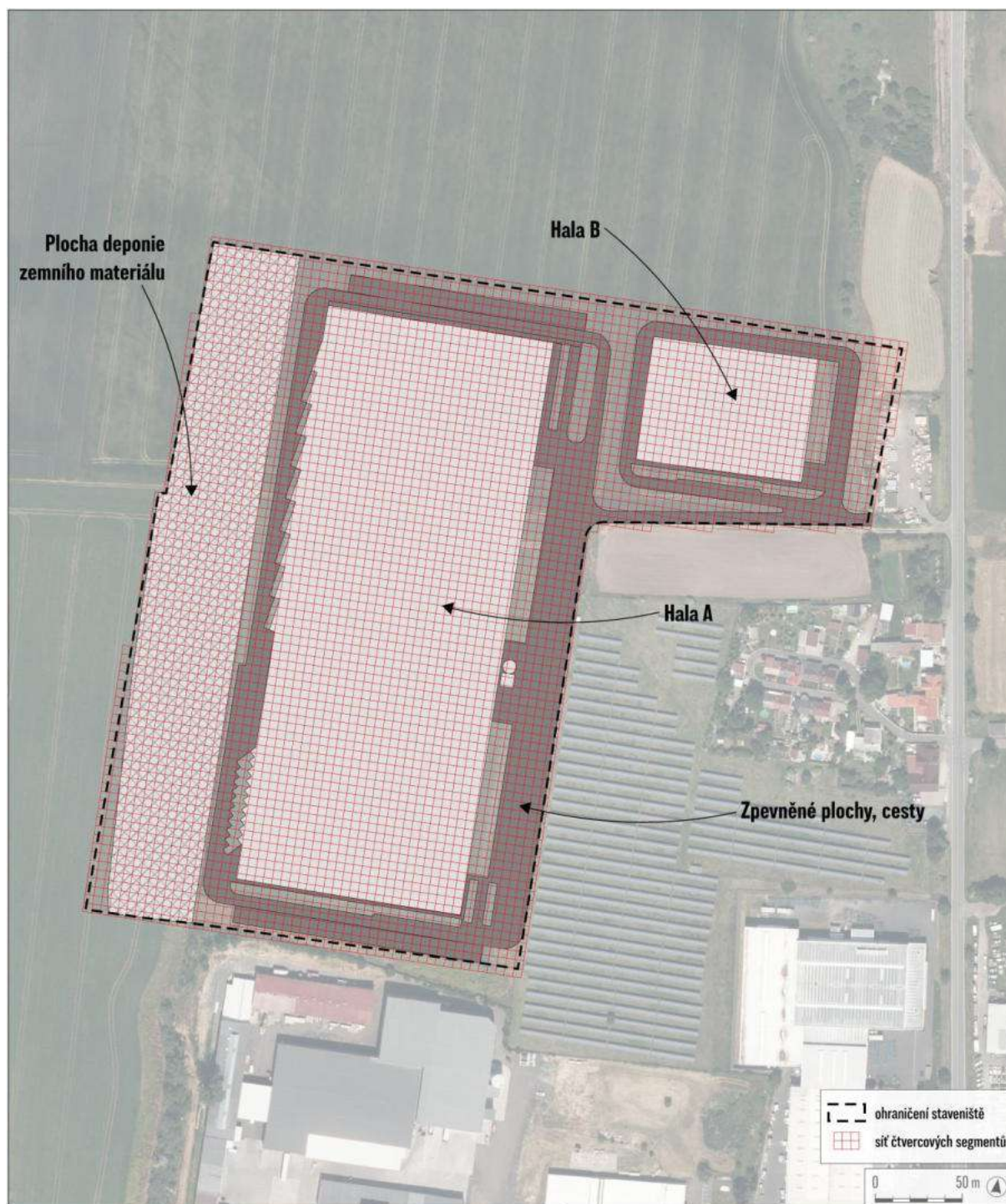
Obrázek 4: Diskretizace prostoru staveniště v místě budoucího logistického areálu do čtvercových segmentů
