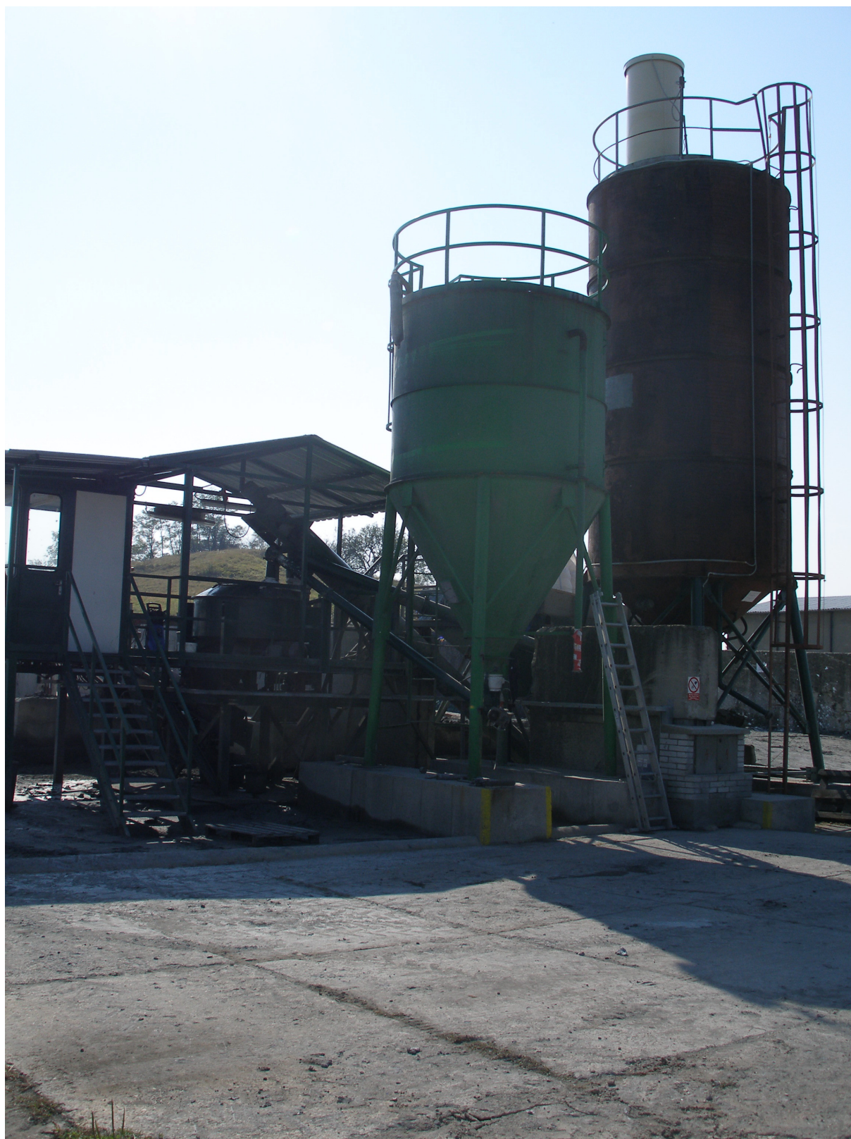
Foto 4: Pohled do sektoru CHARLIE na homogenizér MNB 500 a sila stabilizačních přísad
