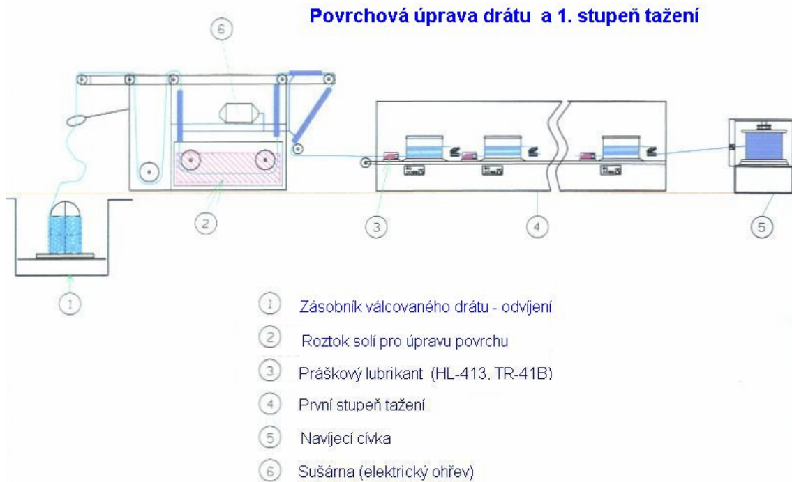
Obrázek č. 4: Povrchová úprava drátu a 1. stupeň tažení
