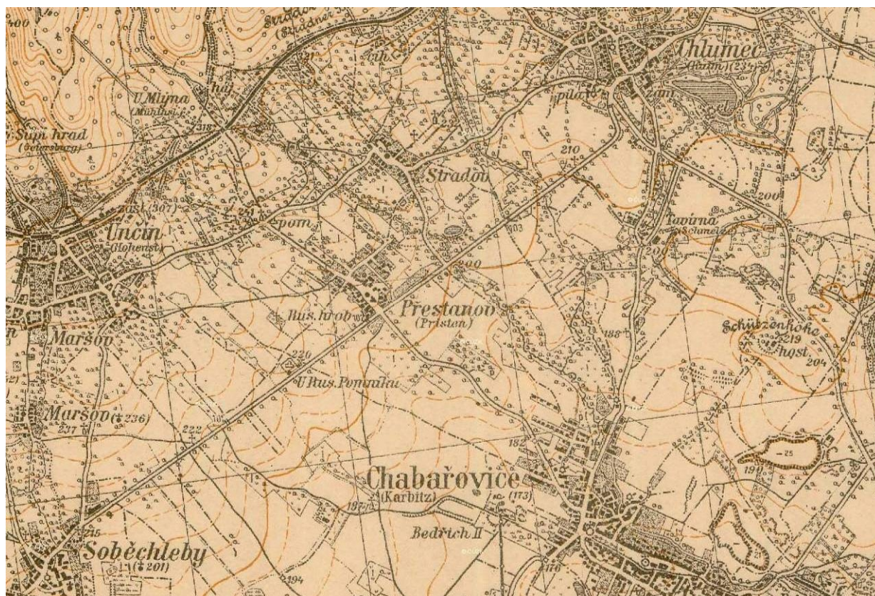
Obr. 3.2.16: Řešené území a jeho okolí na reambulované toposekci III. vojenského mapování z roku 1938. Mapy III. vojenského mapování byly několikrát reambulovány a používány až do roku 1953. K reambulaci v pohraničních oblastech a v okolí velkých měst se přistoupilo v letech 1920-1934. Mapový obsah byl doplněn, polohopisné a výškopisné nepřesnosti byly opraveny a názvosloví počeštěno. Tisk byl dvojbarevný, polohopis, popis a výškové údaje černé, vrstevnice, šrafování a skály hnědé. Mapa zachycuje stejnou situaci jako předchozí speciální mapování. (©Ústřední archiv zeměměřičtví a katastru, http://archivnimapy.cuzk.cz )
