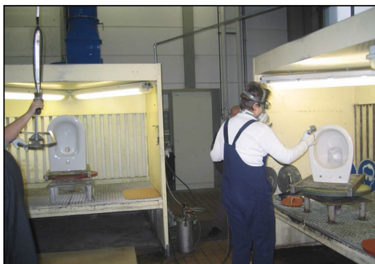
Obrázek 4: Nástřik přípravku ECC (provozovna Biessenhofen, SRN).
