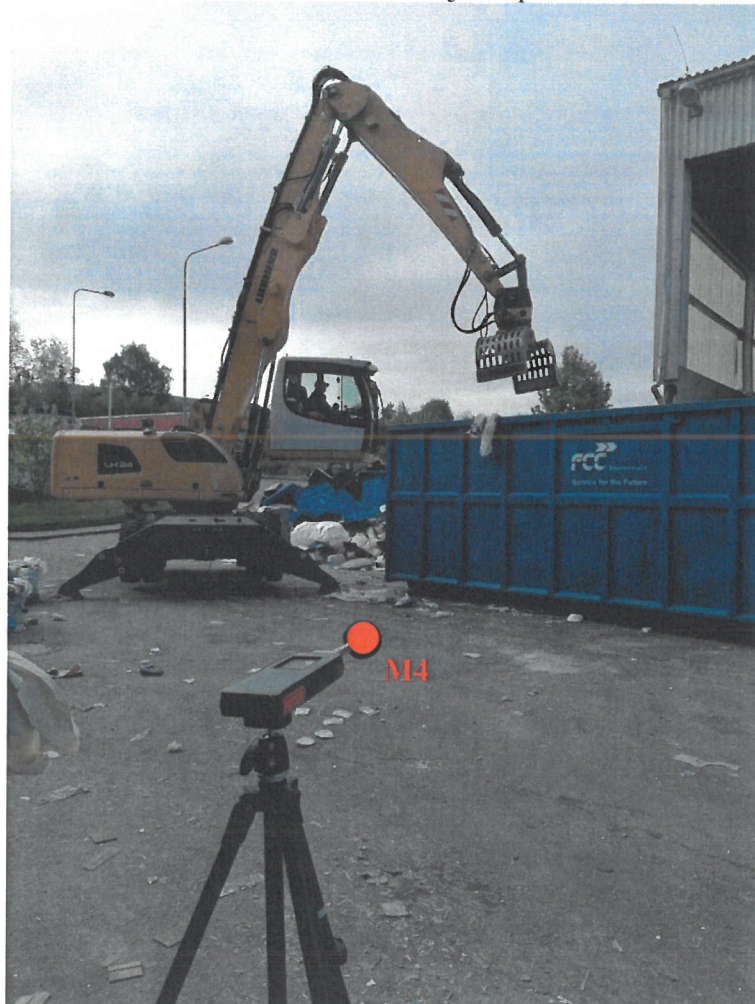
Obr. č. 6: Pohled na místo měření M4 – nakládání kontejneru překladačem Liebherr LH24
