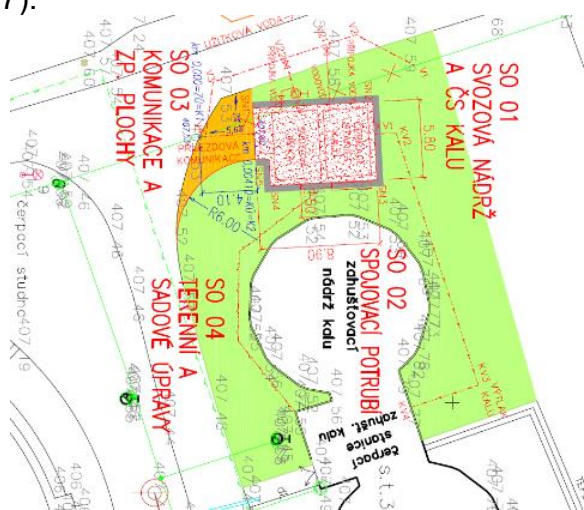
Obrázek č. 7 – Příjezdová komunikace je svozové jímnice a návaznost na stávající komunikaci
