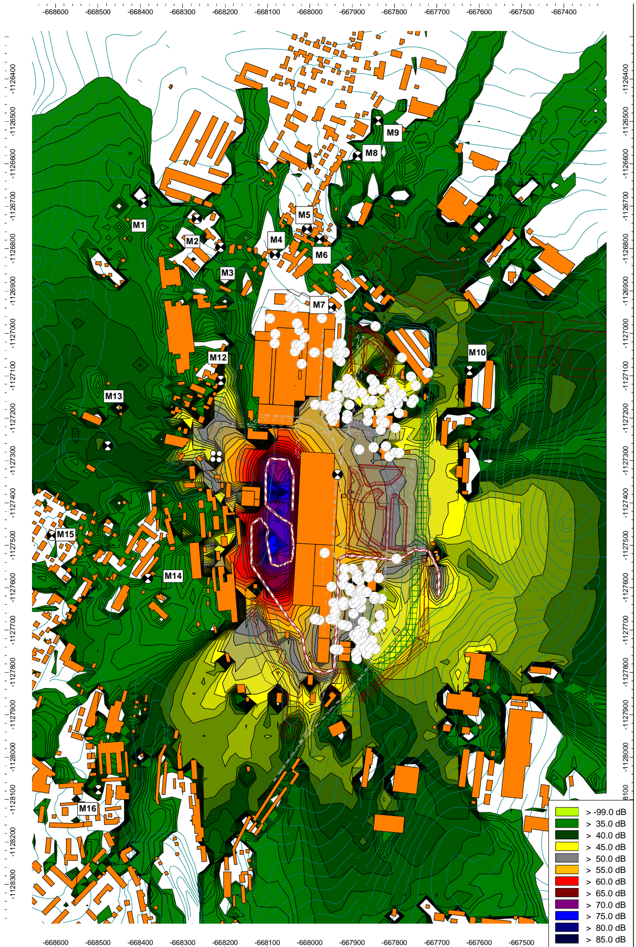
obrázek 7 – pásma hladin akustického tlaku vypočítaná ve výšce 3m nad terénem – hluk ze stavební činnosti v době od 07-21 hod, pouze stavební činnost, denní doba
