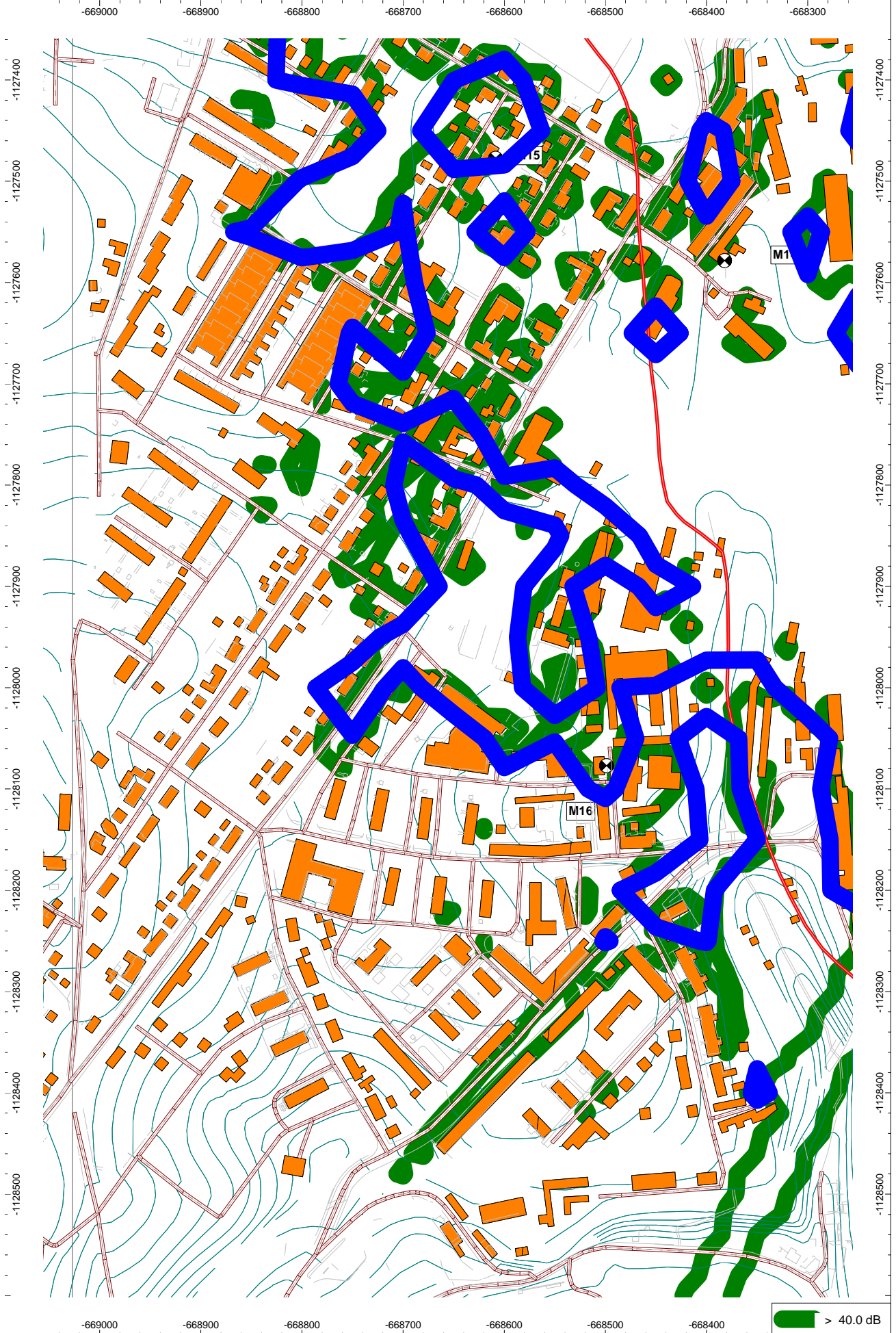
obrázek 11 – porovnání průběhu izofony o hladině 40 dB v počáteční a konečné akustické situaci – noc
