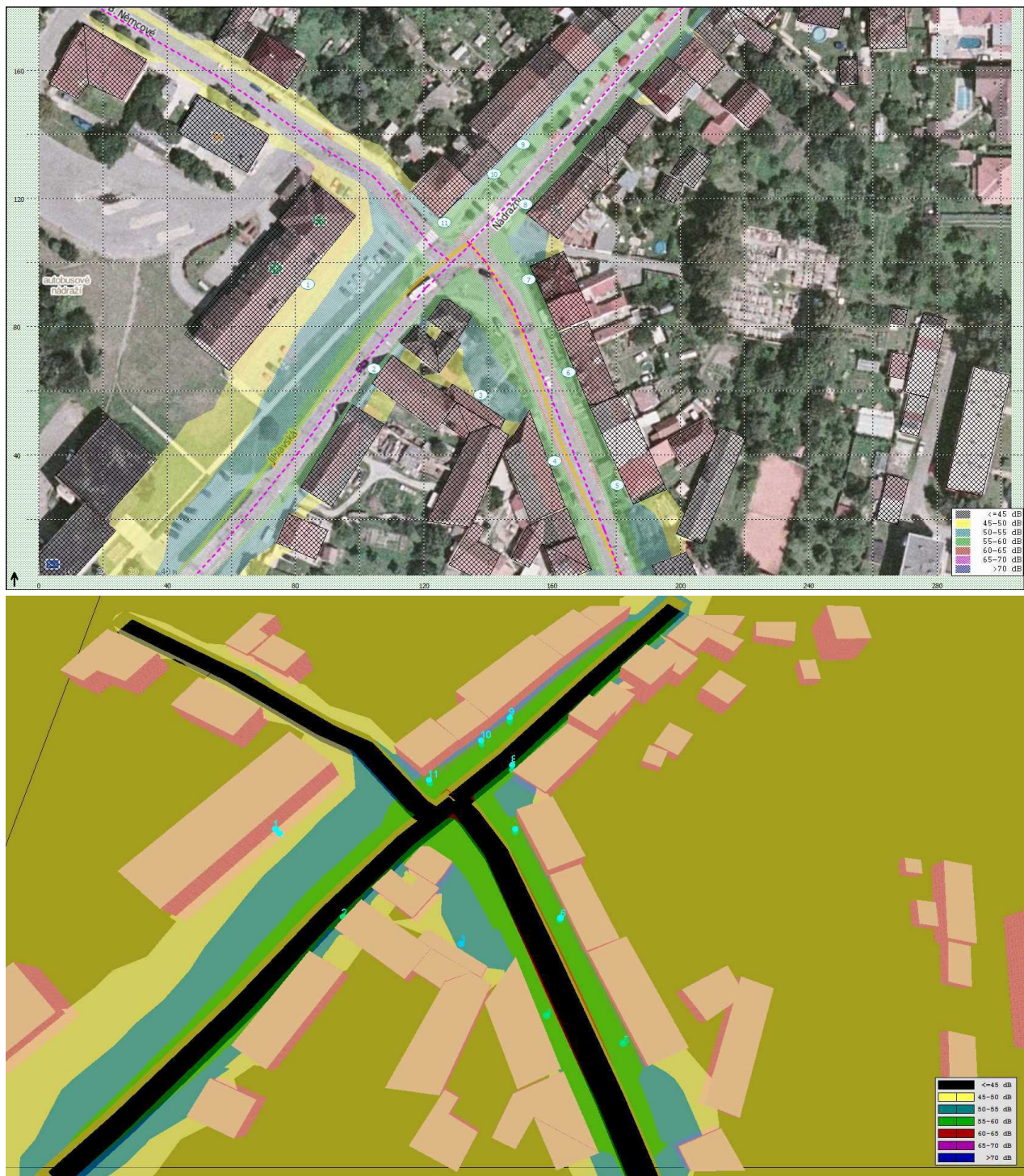
Obr. 6 Grafické znázornění výpočtového modelu - hluk z pozemních komunikací - výhledový stav – nulová varianta - NOC - znázornění pásem izofon - výška izofon nad terénem je 5 m
