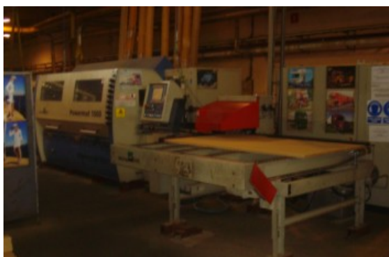
Obrázek 16 : FRIZ – polepování frézovaného materiálu, výkonnost 2 690 dílů/sm.
