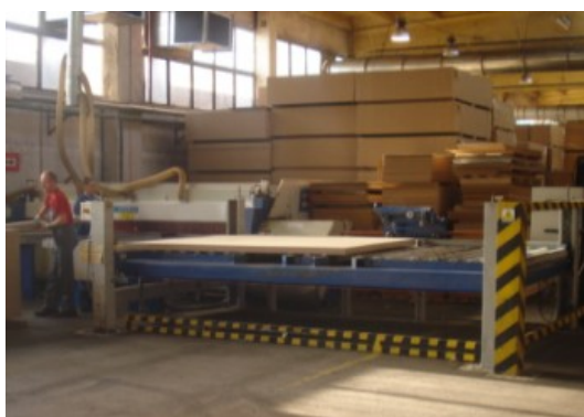
Obrázek 9 : Pila PAUL – řezání desek, výkonnost 500 dílů/sm.
