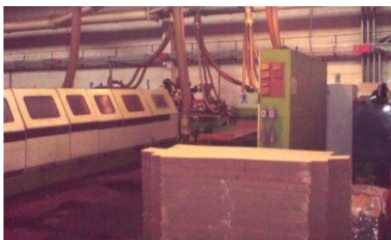
Obrázek 13 : ISE-HOMAG – polepování okrajů a frézování vpustí, výkonnost 350 dílů/sm.
