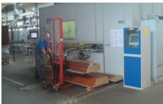
Obrázek 18 : HOMAG M02 a M03 – montáž zámkového plechu a závěsů, výkon. 450 stropů nebo 300 základen/sm.
