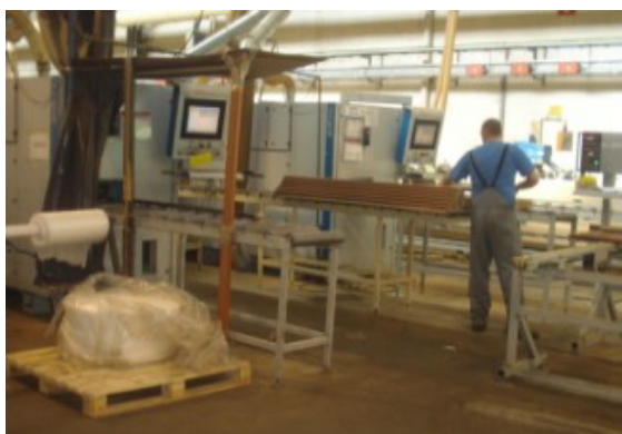
Obrázek 18 : HOMAG M02 a M03 – montáž zámkového plechu a závěsů, výkon. 450 stropů nebo 300 základen/sm.
