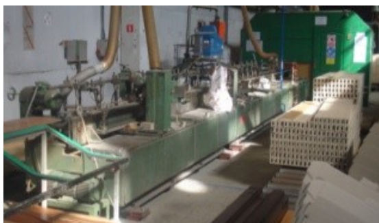
Obrázek 12 : DUESPOHL – polepování lišty, výkonnost 500 dílů/sm.
