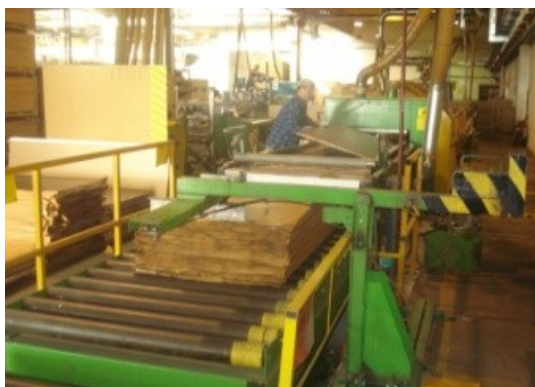
Obrázek 10 : Pila RÜCO – dořezávání dlouhých součástí na stropy, výkonnost 300 dílů/sm.
