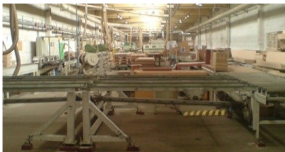
Obrázek 14 : KRAFT – finální montáž a balení zárubní, výkonnost 160 dílů/sm.
