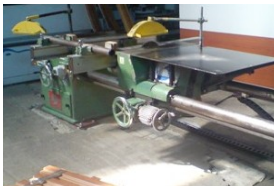
Obrázek 10 : Pila RÜCO – dořezávání dlouhých součástí na stropy, výkonnost 300 dílů/sm.
