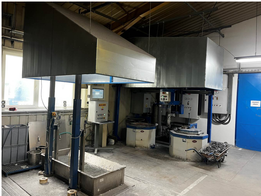
Obr. č. 4 Zdroj č. 102 Zařízení ANNA (vlevo) a 2x tavící pec LAC v hale č. 1
