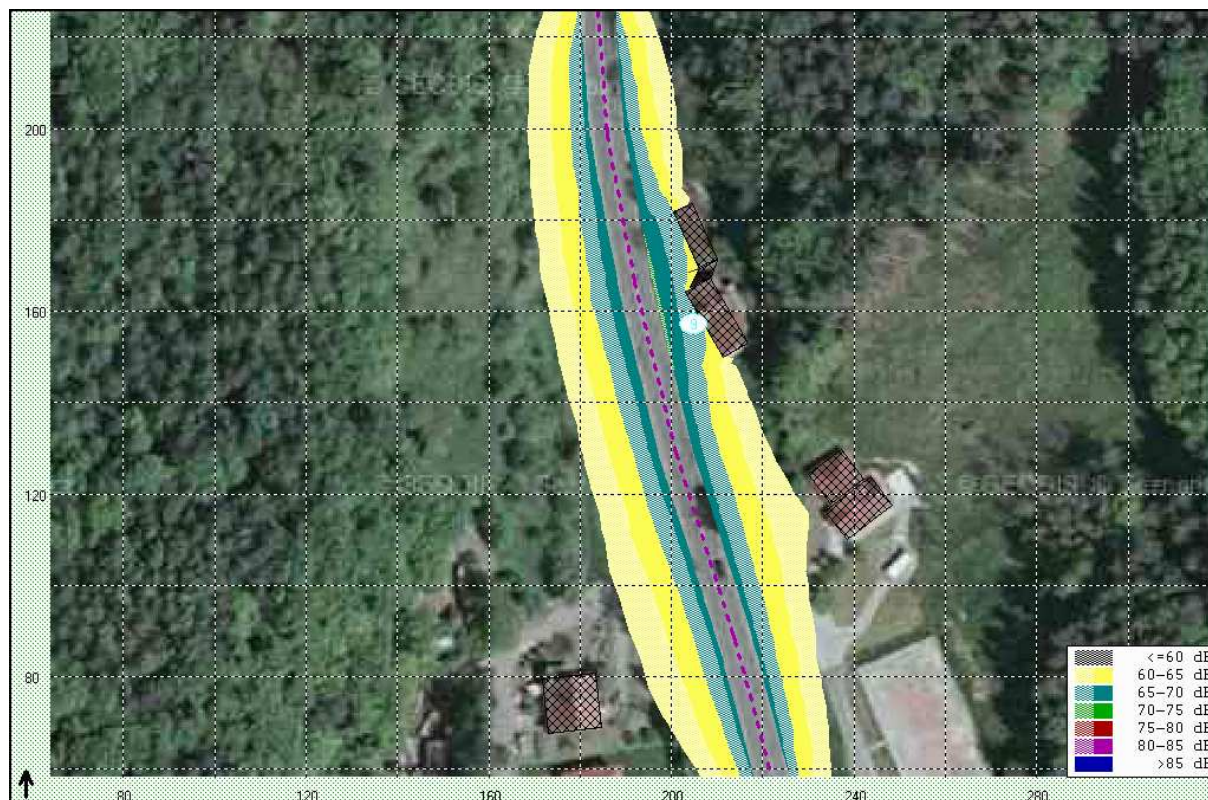
Obr. č. 20. Hladiny dopravního hluku, lokalita E, stav 2010, denní doba
