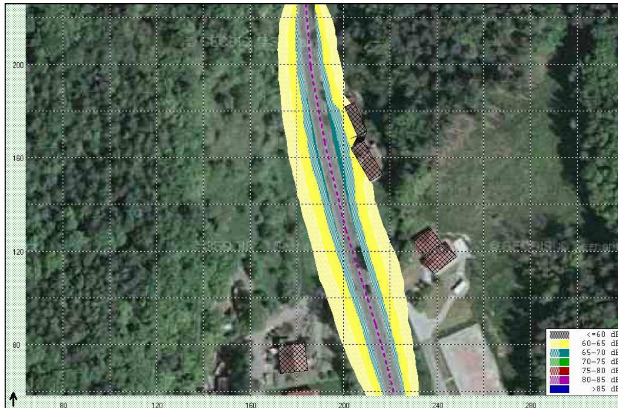
Obr. č. 19. Hladiny dopravního hluku, lokalita E, stav k 1.1.2001, denní doba
