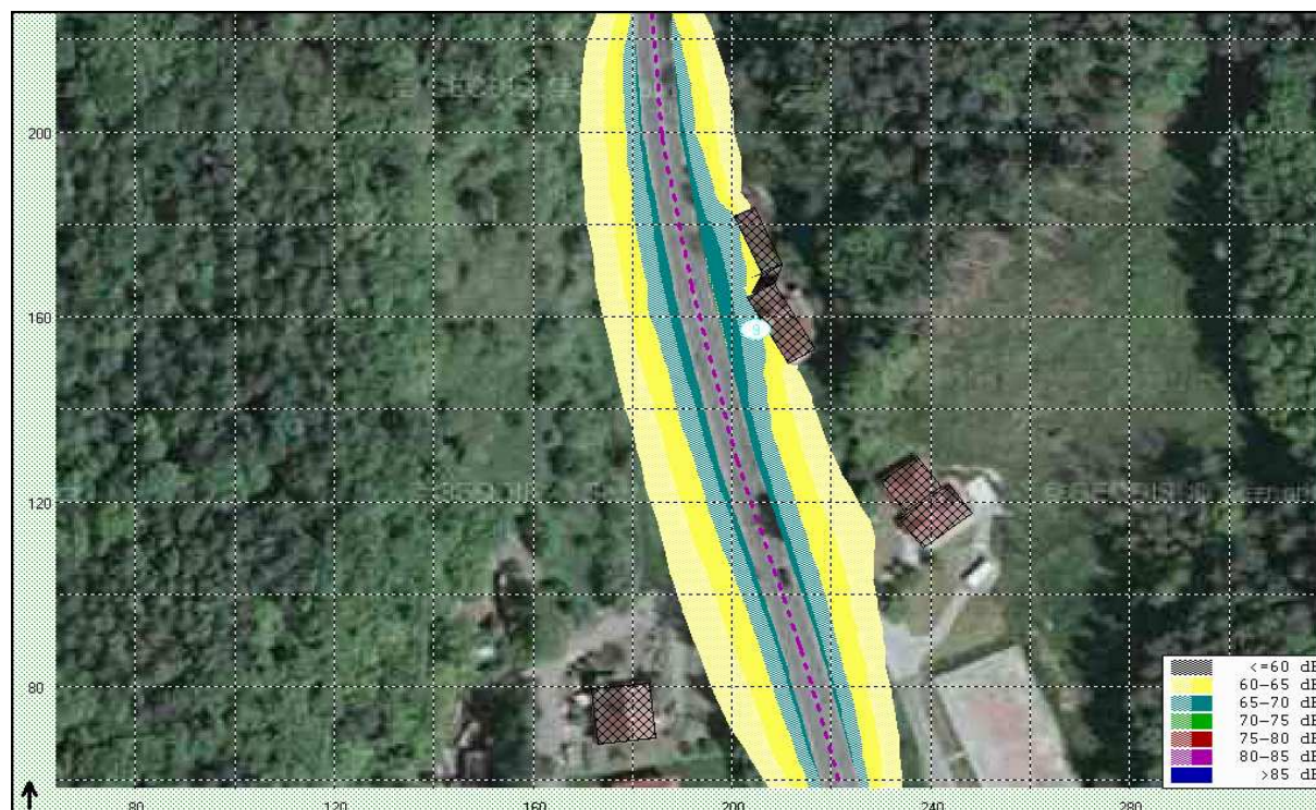
Obr. č. 22. Hladiny dopravního hluku lokalita E, stav po rekonstrukci 2035, denní doba
