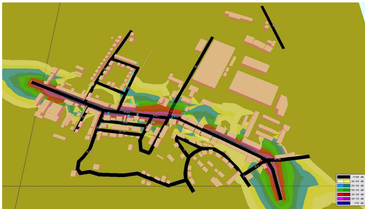
Obr.: Grafické znázornění výpočtového modelu - hluk z pozemních komunikací - budoucí stav - znázornění pásem izofon 2
