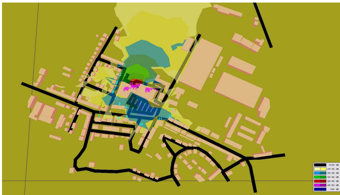
Obr.: Grafické znázornění výpočtového modelu - provoz záměru NOC - znázornění pásem izofon 2
