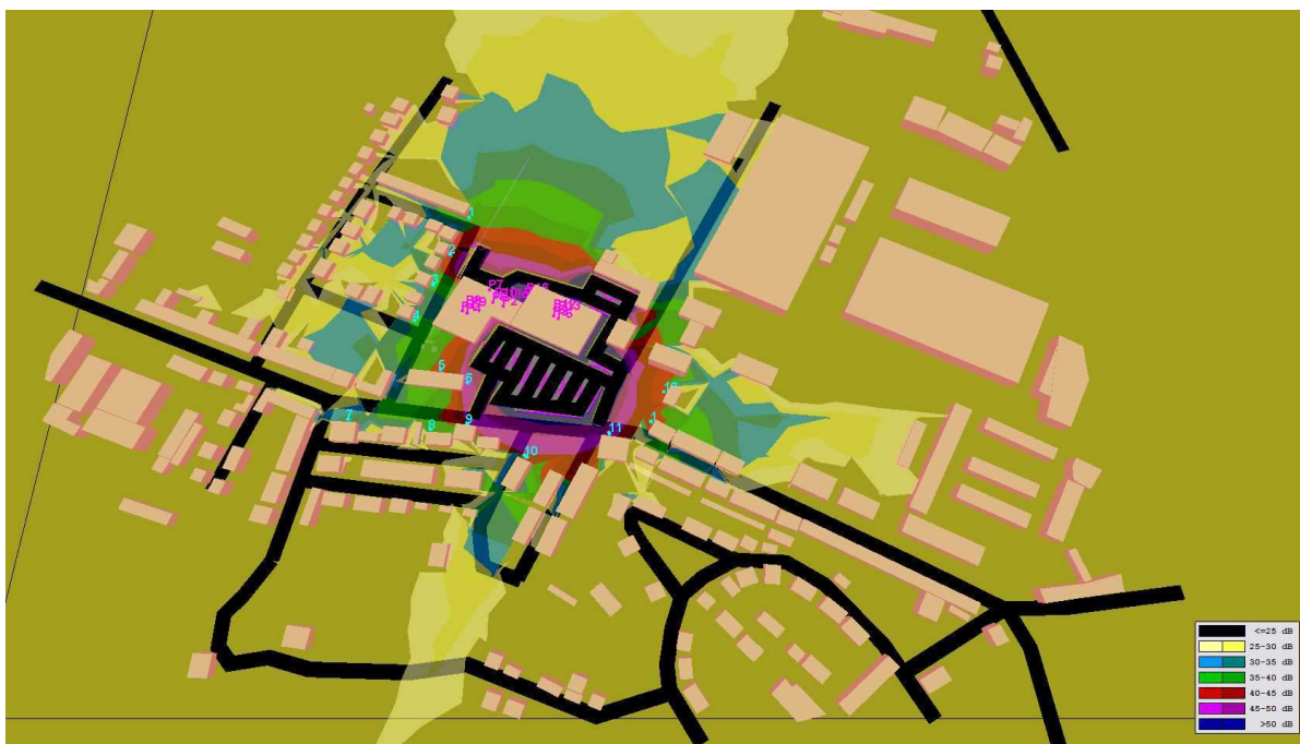
Obr.: Grafické znázornění výpočtového modelu - provoz záměru DEN - znázornění pásem izofon 1
