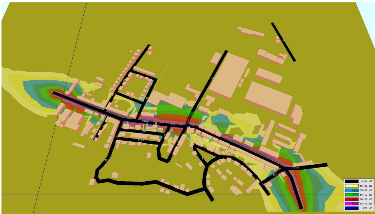
Obr.: Grafické znázornění výpočtového modelu - hluk z pozemních komunikací - budoucí stav - znázornění pásem izofon 2
