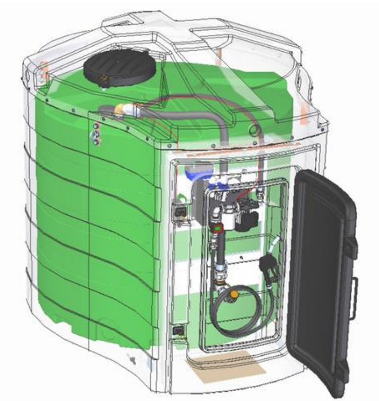
Obrázek 6: Čerpací stanice pohonných hmot typu Harlequin 5000FS Fuel Station
