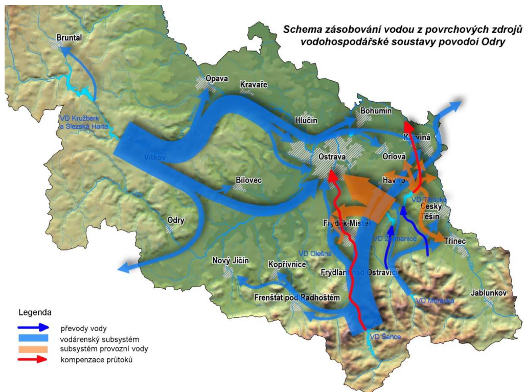
Obrázek 35: Schéma zásobování vodou z povrchových zdrojů MSK
