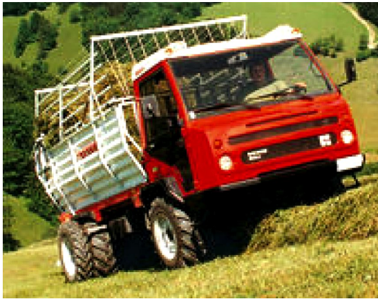
Obr.51: Pro sběr a svoz objemné hmoty – univerzální transportéry s velkoobjemovou nástavbou
