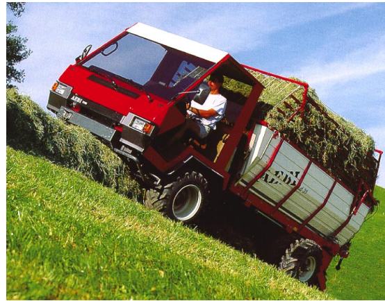
Obr.51: Pro sběr a svoz objemné hmoty – univerzální transportéry s velkoobjemovou nástavbou
