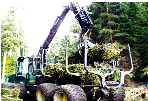
Obr.57: Volně uložené balíky nakládá a vyváží na OM vyvážecí traktor
