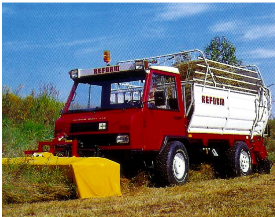
Obr.52: Transportér s žacími stroji transportér s korbou a ramenem
