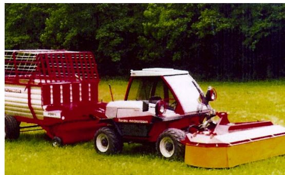
Obr.50: Univerzální horské traktory mohou aktivně používat adaptéry vpředu i vzadu
