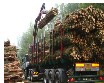
Obr.55: Technika pro úklid dendromasy z lesa
