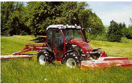
Obr.50: Univerzální horské traktory mohou aktivně používat adaptéry vpředu i vzadu
