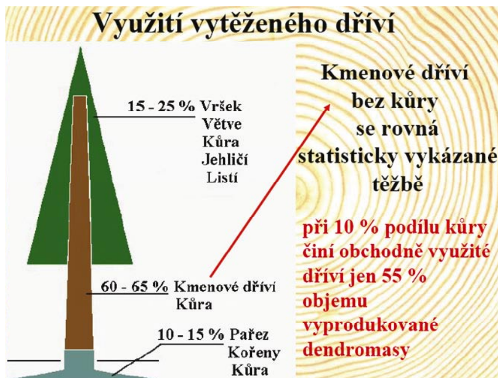
Obr.54: Využití vytěženého dříví
