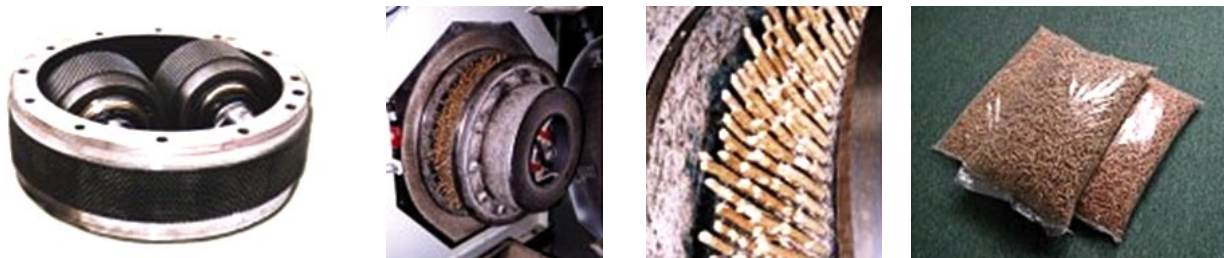
Obr.68: Matrice pro lisování; Granulační ústrojí; Pelety procházející matricí; Výsledný produkt
