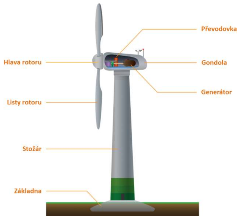
Obrázek 2: Popis základních částí větrné elektrárny.
