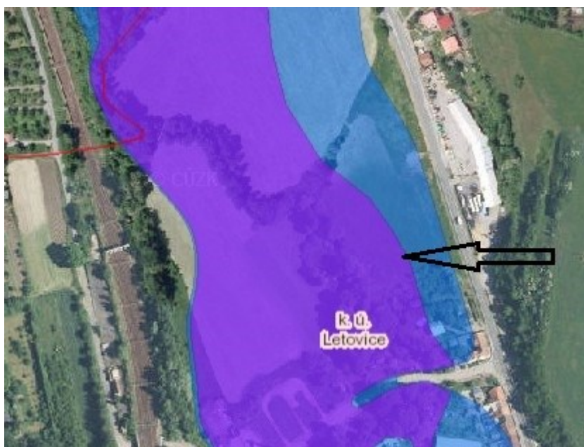
Obr. 2 Vymezení záplavového území v lokalitě. Šipkou je vyznačena hranice aktivní zóny záplavového území Svitavy.
