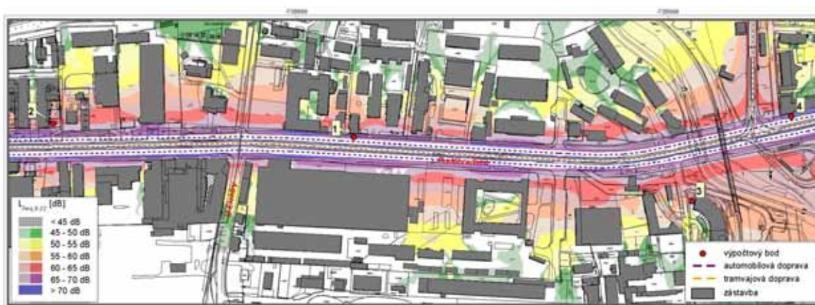
Obr. 20: L_{Aeq} [6 až 22 hod], stav bez realizace záměru, rok 2018, izofony ve výšce 3 m nad terénem
